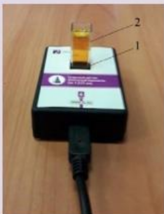
Рис. 1. Датчик оптической плотности: 1 — гнездо для кюветы; 2 — кювета для исследуемого вещества
